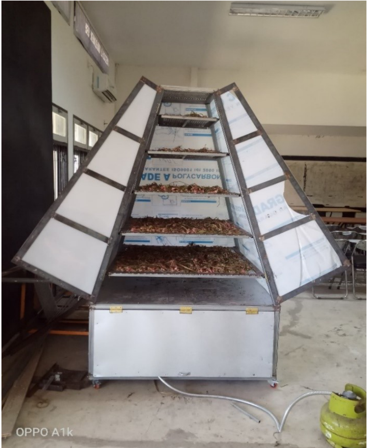
Figure 11. Produk jadi Mesin Pengering Bawang Merah
